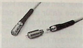
Bild 1: Optische Digitalübertragungssysteme für Bitraten bis 10 Mbit/s und 22 km Entfernung (Hirschmann-Pressbild)
