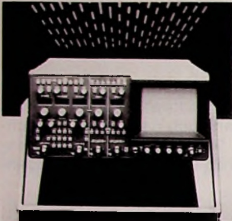
Bild 3: Schnelles Hochfrequenz-Oszilloskop PM 3295 (Philips-Presebild)
