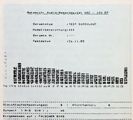
Bild 7: Ausgedruckter Frequenzgang eines Cassetten decks mit falsch eingestellter Vormagnetisierung
