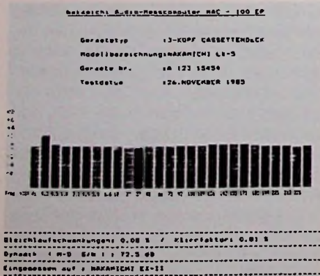
Bild 10: Vollständiger Ausdruck eines Meßprotokolles, so wie es der Benutzer des HI-FI-Gerätes mitbekommt
